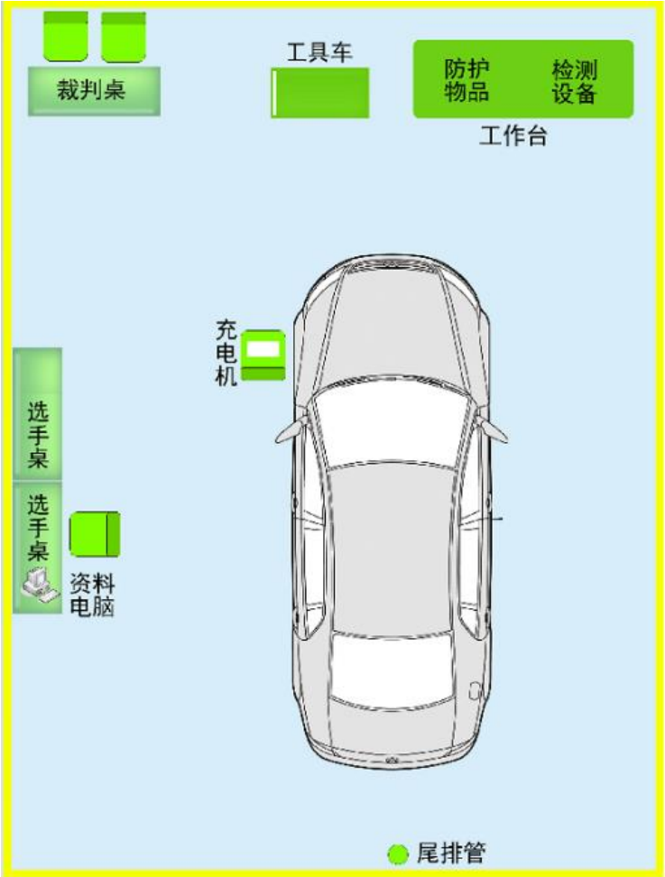
图 3 整车竞赛工位布置图
